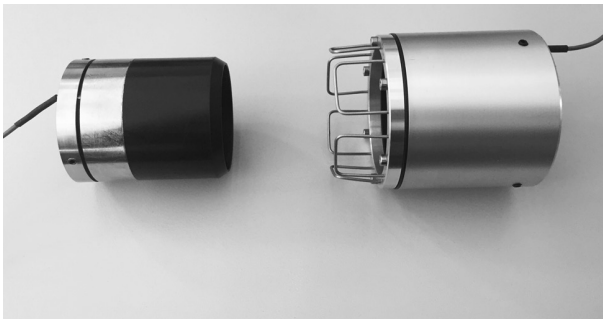
Bild 7. Kontaktlose Kupplungen im Düsenstrahlgestänge.
