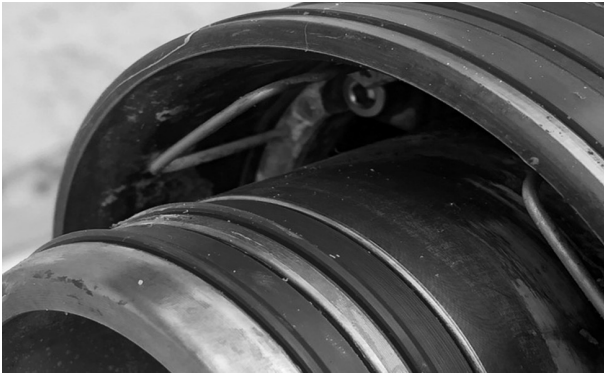
Bild 9. Kontaktbügel der Kupplungen im Düsenstrahlgestänge.
