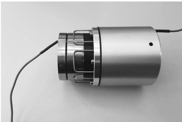
Bild 8. Kontaktleitende Kupplungen im Düsenstrahlgestänge.
